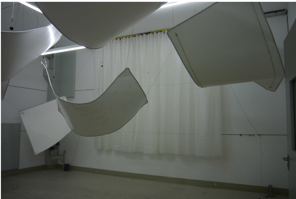
Abbildung B.2. Geraffte Anordnung, Prüfanordnung im Hallraum.
