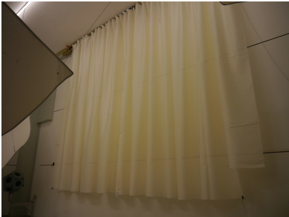
Abbildung B.2. Geraffte Anordnung, Prüfanordnung im Hallraum.
